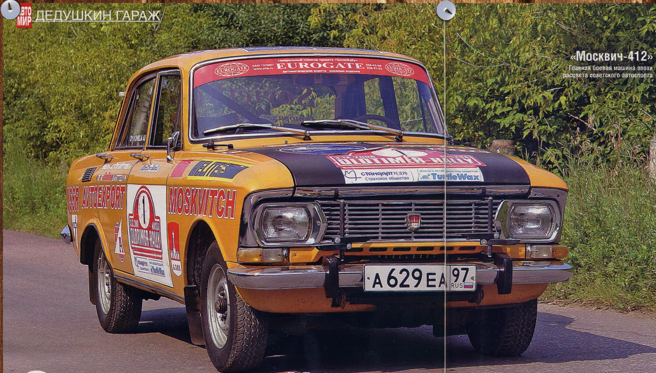
Кронштейны на кузове и передней решетке предназначены для крепления дополнительной навесной светотехники
