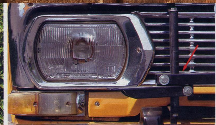
Кронштейны на кузове и передней решетке предназначены для крепления дополнительной навесной светотехники
