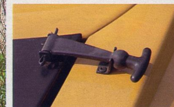
Капот и багажник фиксируют дублирующие наружные замки
