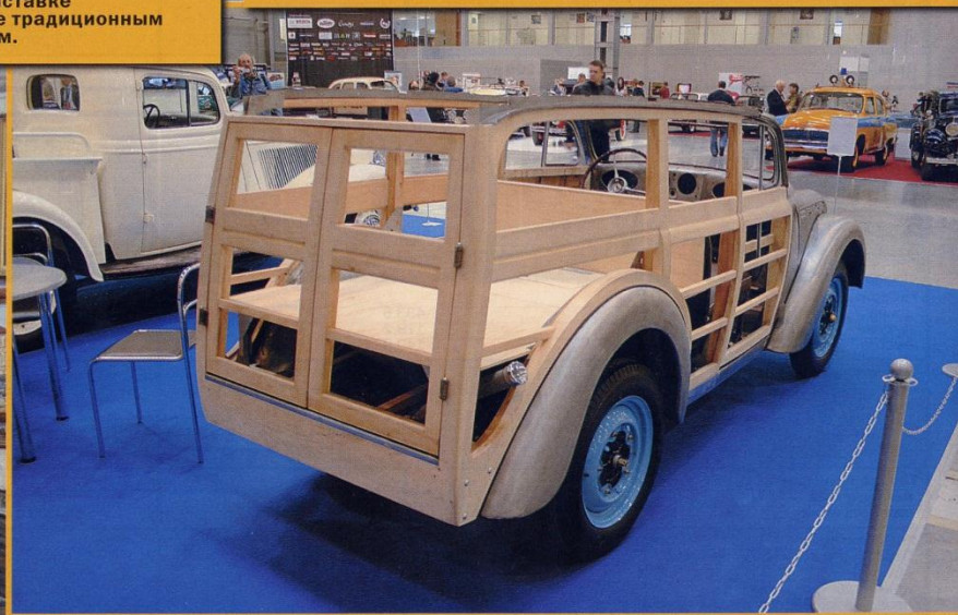
После Второй мировой войны стальной прокат был в дефиците, поэтому при создании новых моделей советские инженеры использовали опыт американских коллег, использовавших древесину в качестве основного материала для кузова. В результате получались такие автомобили, как этот редчайший "Москвич-422" 1954 года выпуска. Детали его каркаса изготавливались из березы, а затем скреплялись специальным клеем и болтами. Боковые панели были фанерными, а крыша покрывалась дерматином.
