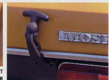
Кронштейны на кузове и передней решетке предназначены для крепления дополнительной навесной светотехники
