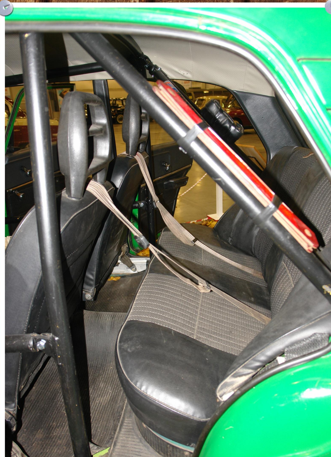
Задний каркас безопасности и спортивные трехточечные ремни
