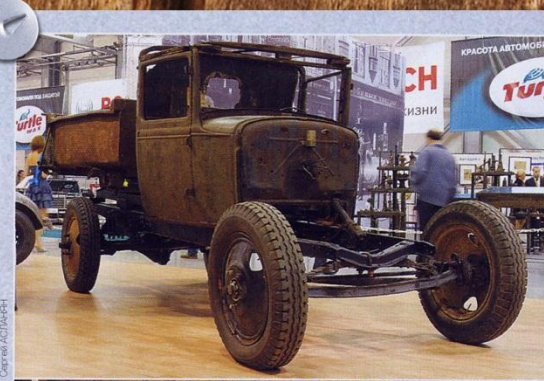
Один из первых советских самосвалов на шасси грузовика ГАЗ-ММ 1946 года с удивительной системой подъема кузова. Редчайшая 21-я с гидромеханическим сцеплением, которое по инерции принимают за автоматическую коробку передач.
