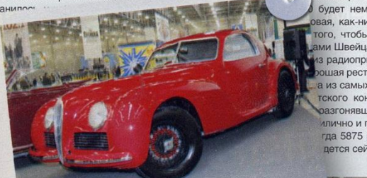
Редкая «Альфа-Ромео 6С 2500СС» 1939 года из коллекции «Клуба кабриолетов и родстеров». На такие ставили 2,5-литровые «шестерки» мощностью до 110 л.с.
