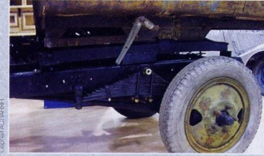
Один из первых советских самосвалов на шасси грузовика ГАЗ-ММ 1946 года с удивительной системой подъема кузова. Редчайшая 21-я с гидромеханическим сцеплением, которое по инерции принимают за автоматическую коробку передач.
