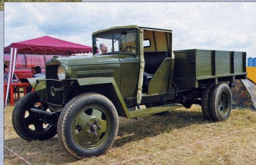
Полноприводный «Москвич-410». Прекрасно отреставрированный ГАЗ-ММ-В 1942 года. Второй фары, дверей и некоторых других деталей у него не было от рождения. Конструкторы упростили его насколько возможно. В войну и так сойдет.
