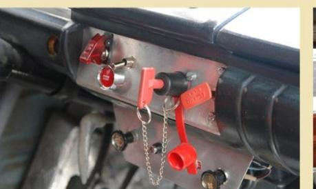
Выключатель зажигания, кнопка стартера, выключатель всех электрических цепей - все доступно с места гонщика.
