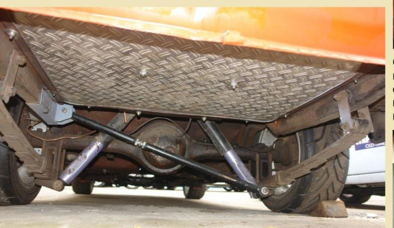
На автомобиле установлены стандартные рессоры через приставки, хотя лучше работают рессоры практически с прямыми листами. Диагональная тяга - для сдерживания поперечного перемещения моста.
