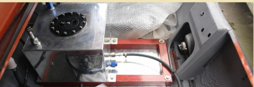
Допускаются два варианта бензобака - спортивный и стандартный, а аккумулятору место в багажнике.
