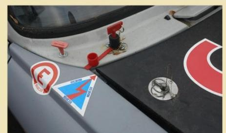
Выключатель электропитания, активация системы пожаротушения и замки капота также обязательны.
